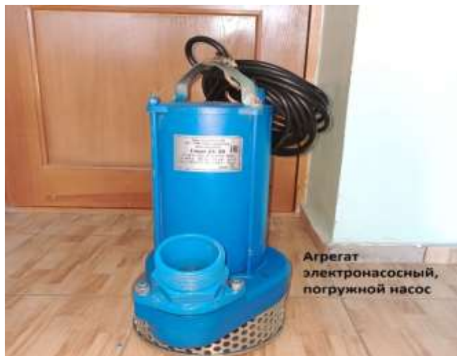
2.1. Ағынды суларға арналған батырылатын сорғы
